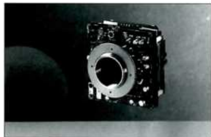
Kleurencameramodule VCM 41, afm. (h x b x d) 63 x 65 x 53 mm.
